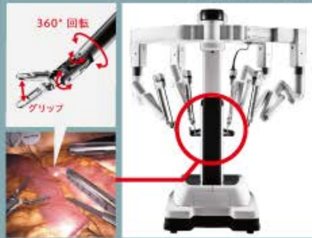
ダビンチには様々なタイプの鉗子や尖刀などが装備されている。鉗子の関節は360度回転。体内の深い場所や狭い視野でも自在に動かせるため、細かい操作が可能となる
